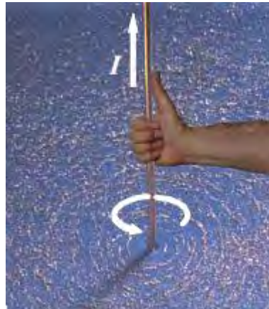
Figura 3.3 Pamje tredimensionale të fushës magnetike që rrethon një përcjellës me rrymë.
