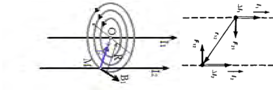
Figura 3.6 Paraqitja e dy përcjellës të cilet në një largësi a nga njëri tjetri, përshkohen nga rrymat I_1 dhe I_2 .
