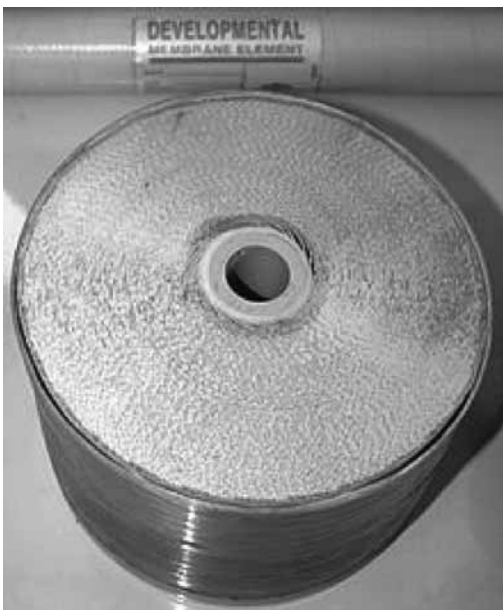
Figura 1. Pamje nga osmoza riverse e përdorur për përpunimin e ujit dhe membranat e osmosës
